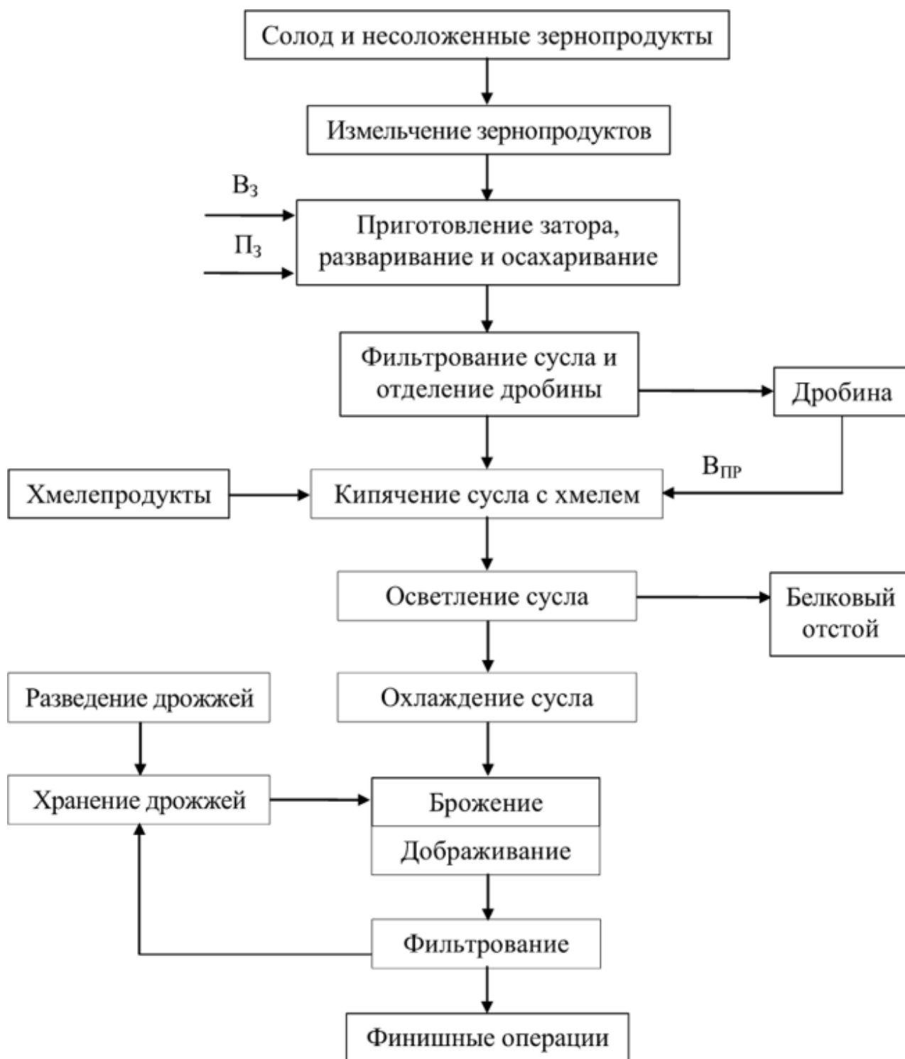
Рисунок 1. Схема технологии производства пива.
